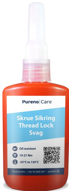
Skrue Sikring Svag er udviklet til låsning og forsegling af gevindbeslag, der kræver nem demontering med standard håndværktøj. Produktet hærder ved udelukkelse af luftens ilt og i kontakt med tætsluttende metaloverflader. Forhindrer løsning og lækage ved chok belastning og vibrationer. Kan benyttes i temperaturer fra -55°C til 155°C. Styrke 10-21 Nm.
