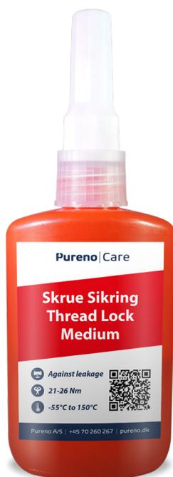
Skrue Sikring Medium er udviklet til låsning af gevindbefæstelser som skal kunne demonteres med almindeligt håndværktøj. Det forebygger at vibrerende dele som gearkasser, pumper, løsner sig. Produktet hærder ved udelukkelse af luftens ilt og i kontakt med tætsluttende metaloverflader. Forhindrer løsning og lækage fra chok belastning og vibrationer. Kan benyttes i temperaturer fra -55°C til 155°C. Styrke 21-26 Nm.
